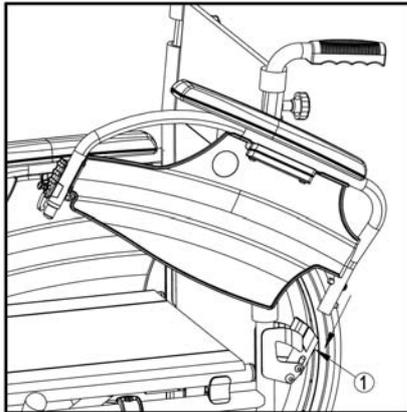
1. Schieben Sie das hintere Rohr der Armlehne in die Rohraufnahme ①.
