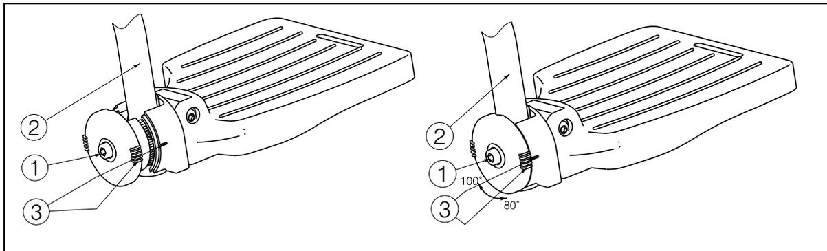
So stellen Sie den Fußplattenwinkel ein:
