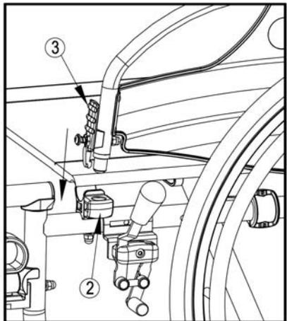
4. Schieben Sie das vordere Rohr der Armlehne in die Rohraufnahme ②.
