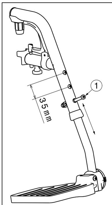
So stellen Sie die Länge der Fußauflage ein (3 mögliche Positionen: Schritte von 35 mm → Bohrungen Außenrohr, 6 mögliche Positionen: Schritte von 25 mm → Innenrohr):
