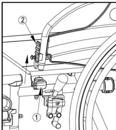
1. Drücken Sie den Hebel ② und ziehen Sie die Vorderseite der Armlehne nach oben.
