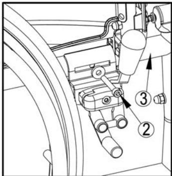
3. Lösen Sie die Schraube ②, so dass der Bremsmechanismus über die Führung ③ geschoben werden kann.
