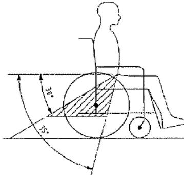
5. Je größer (steiler) der Winkel des Gurtriemens innerhalb der markierten Fläche, desto besseren Halt kann das Gurtsystem bieten.
